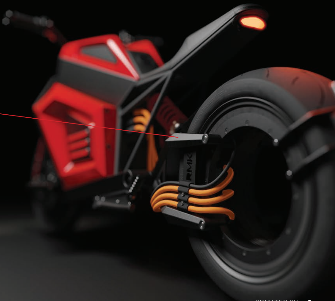
COMATEC TOTEUTTI E2:n takahaarukkaan 3D-mallit ja piirustukset.
